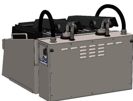
Bag på maskinen er det muligt at justerer toppanden hvis den ikke er parallel med bundpanden, det gøres på en pinolskrue bag på armen (se billede)
